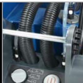
Mit dem Fuß zu bedienender Ein-/Ausshalter und Funktionswahlschalter
